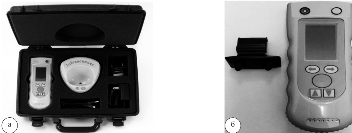
Рис. 1. Общий вид переносного контейнера с компонентами системы «IM2000S» (а) и общий вид аппарата с одноразовым светодиодом (б)
